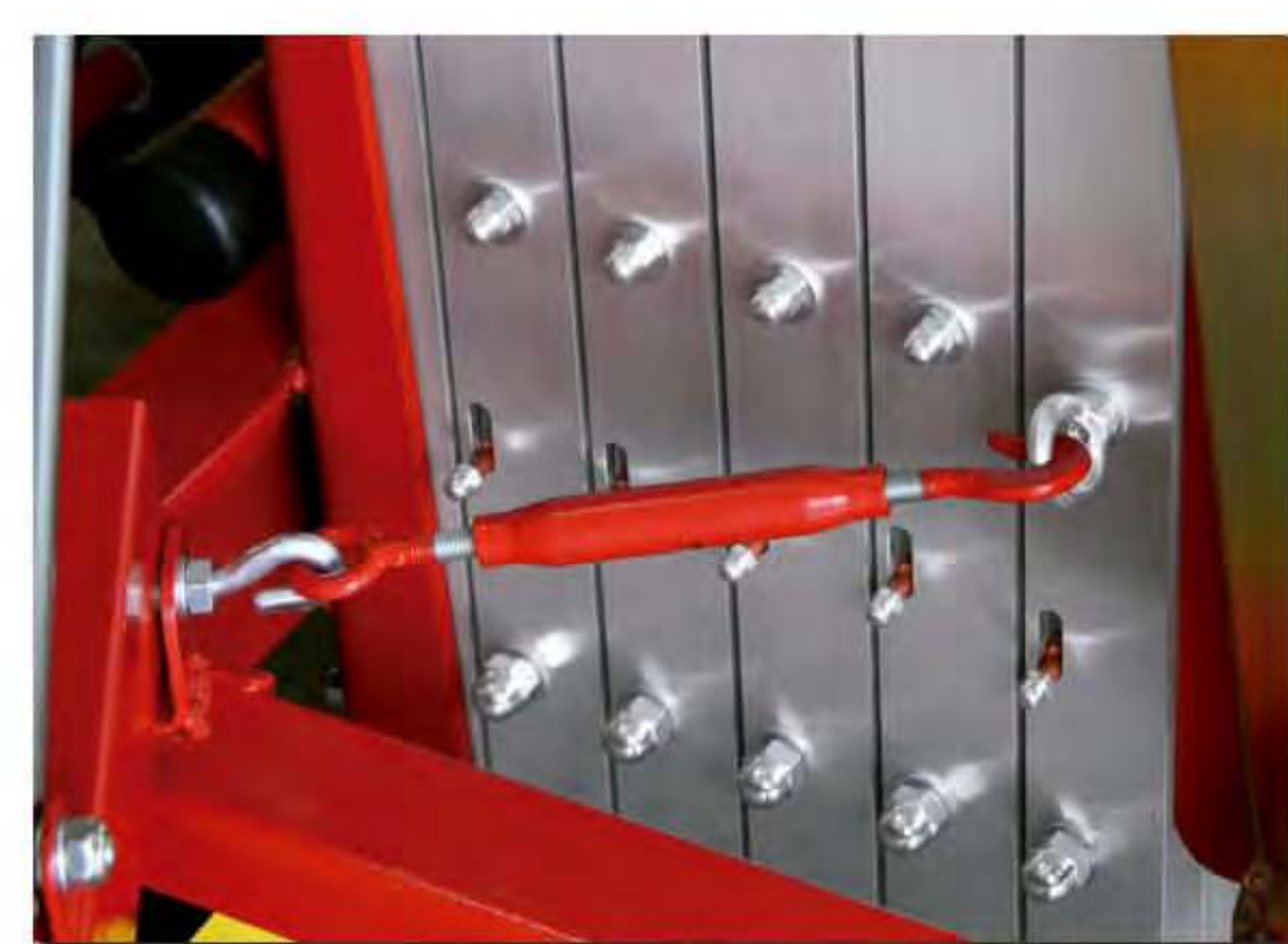
Justerbar mast blokeringsystem ved vandret transport
