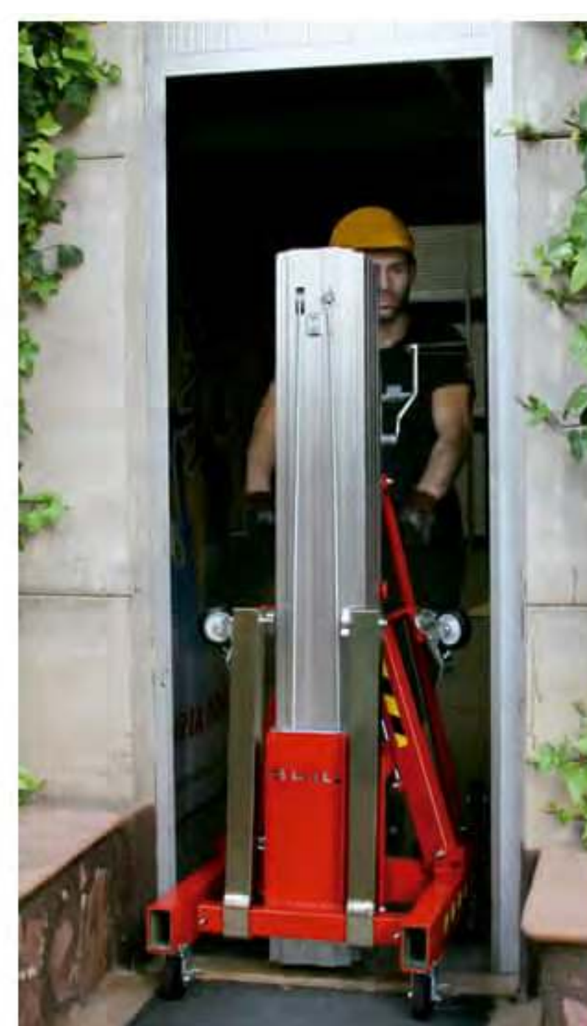
Kompakt design og 12 hjul inkluderet for nem manøvrering (Horisontalt og vertikalt)
