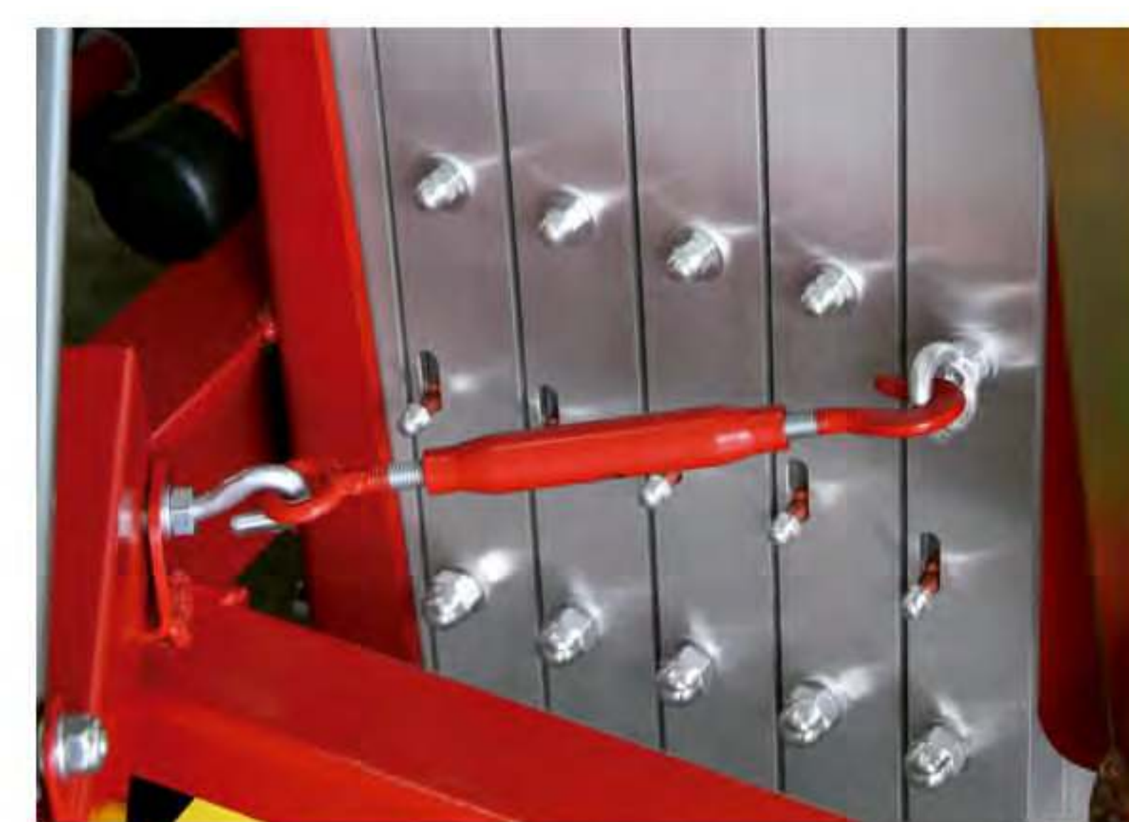
Justerbar mast blokeringsystem ved vandret transport
