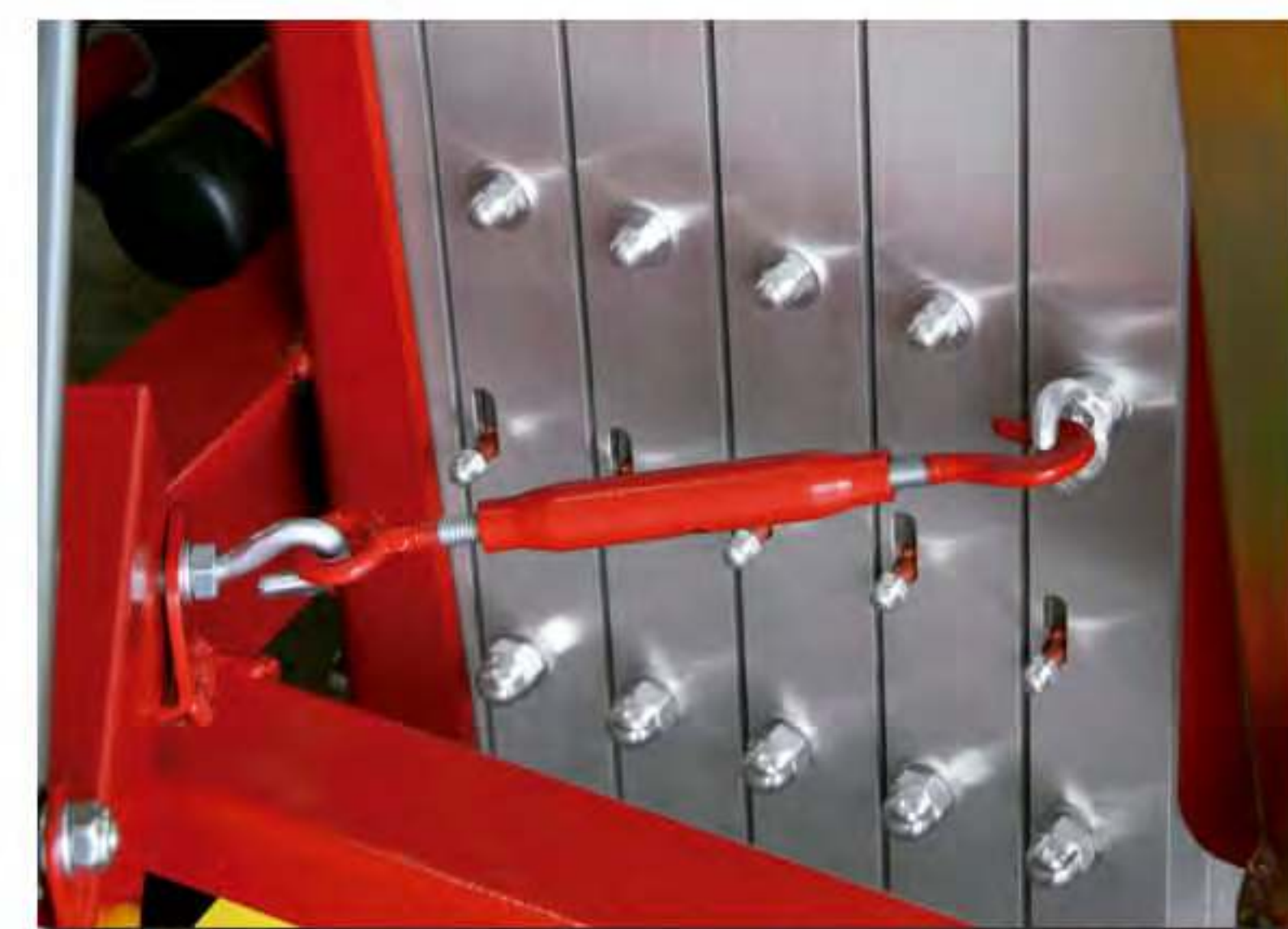
Justerbar mast blokeringsystem ved vandret transport
